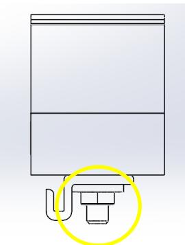
**02. Posicionar o clamp engatando o enrijecido na terça (img01) e abraçando a placa solar (img 02) deixando a lateral da placa encostado com a lateral do fixador (img 03).**
